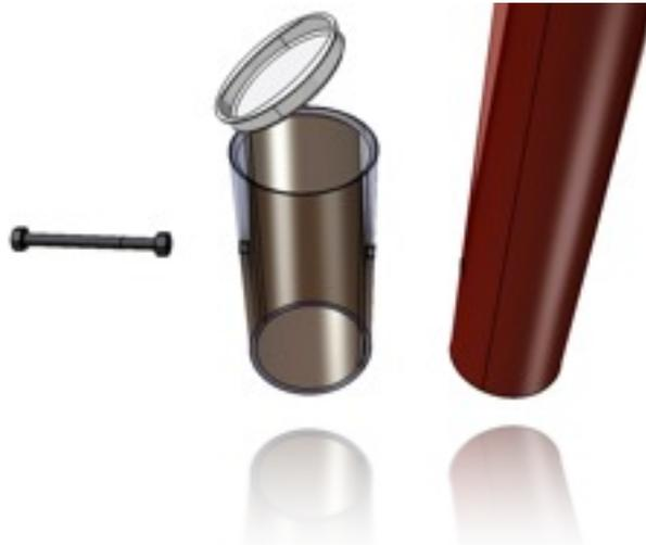
Il est percé d'un trou de diamètre 11 mm à 100 mm du fond de fourreau. BornFlex® est également percé d'un trou de 11 mm à 100 mm de son extrémité inférieure, permettant son maintien dans le fourreau à l'aide d'une vis et d'un écrou M10 fournis dans le kit de montage **BornFix®1**.
